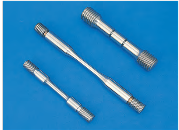
Round Tensile Specimens
